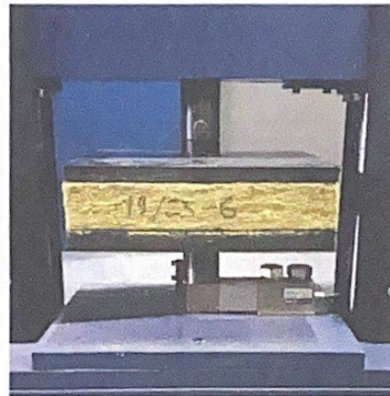
Рисунок 6 – Проведення випробування міцності на стиск при 10% деформації зразків № 19/23 теплоізоляційного матеріалу марки «ТЕХНОРУФ 45»
