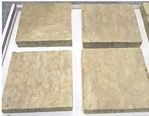
Рисунок 9 — Зволоження дослідних зразків № 19/23 теплоізоляційного матеріалу марки «ТЕХНОРУФ 45»
