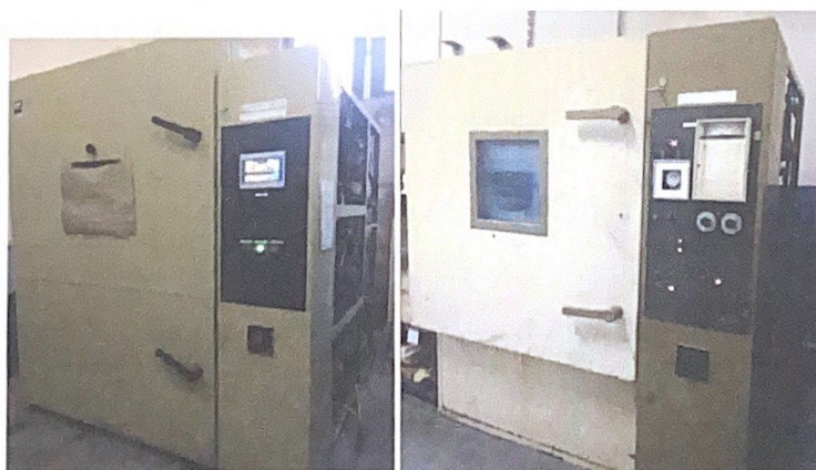
Рисунок 3 – Кліматичні камери для проведення циклічних кліматичних впливів
